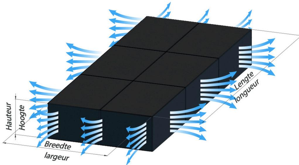
$$2 \times (\text{longueur} + \text{largeur}) \times \text{hauteur} = \text{Surface d'infiltration (m}^2\text{)}$$
